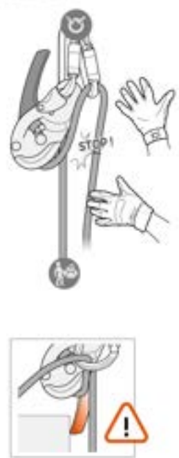
11c. Stop position Position d'arrêt
