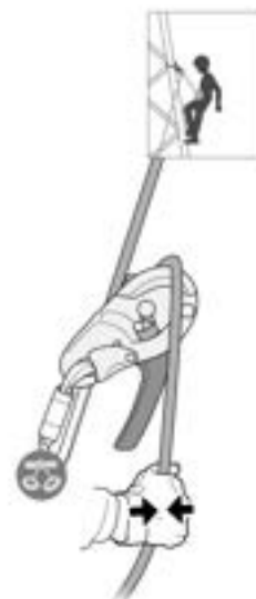
10e. Always hold the brake-side rope when the climber is moving. Tenez toujours la corde côté freinage lors des déplacements du grimpeur
