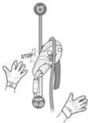
10c. Stop position Position d'arrêt
