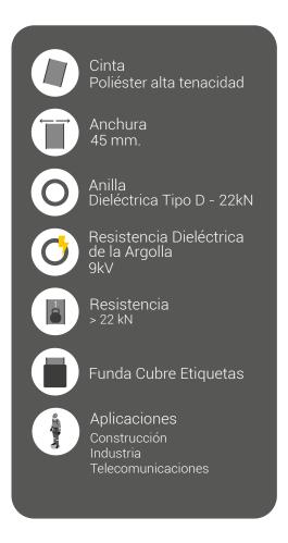
Dispositivo de anclaje textil Ojo-Argolla, la cinta de anclaje EQS funciona un punto de anclaje temporal. Especialmente diseñada para su instalación sobre postes de madera, hormigón y vigas estructurales.
