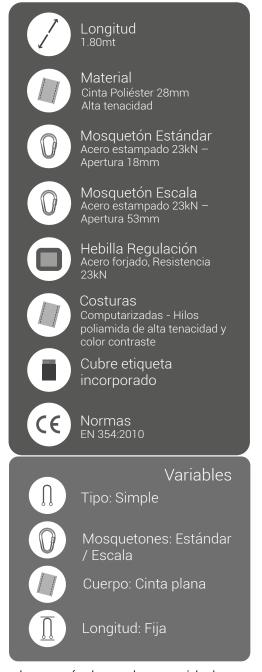
El cabo de restricción EQS esta confeccionados de acuerdo a los más altos estándares de seguridad, diseñado para labores de restricción de caídas.
