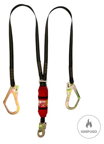
El Absorbedor de impacto EQS forma parte de un sistema personal de detención de caídas, es un equipo diseñado para mitigar las fuerzas de impacto que experimenta una persona en caso de una caída desde altura. Esta absorción de energía ayuda a prevenir lesiones al desacelerar gradualmente la caída en lugar de detenerla abruptamente. Este dispositivo reduce la fuerza de impacto ampliando la distancia de desaceleración, permitiendo que la fuerza que recibe el usuario se reduzca a menos de 6kN.
