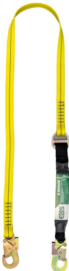
El absorbedor de impacto EQS forma parte de un sistema personal de detención de caídas, es un equipo diseñado para mitigar las fuerzas de impacto que experimenta una persona en caso de una caída desde altura. Esta absorción de energía ayuda a prevenir lesiones al desacelerar gradualmente la caída en lugar de detenerla abruptamente. Este dispositivo reduce la fuerza de impacto ampliando la distancia de desaceleración, permitiendo que la fuerza que recibe el usuario se reduzca a menos de 6kN.
