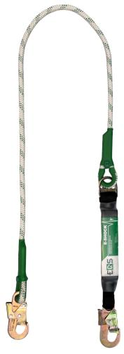
El absorbedor de impacto EQS forma parte de un sistema personal de detención de caídas, es un equipo diseñado para mitigar las fuerzas de impacto que experimenta una persona en caso de una caída desde altura. Esta absorción de energía ayuda a prevenir lesiones al desacelerar gradualmente la caída en lugar de detenerla abruptamente. Este dispositivo reduce la fuerza de impacto ampliando la distancia de desaceleración, permitiendo que la fuerza que recibe el usuario se reduzca a menos de 6kN.
