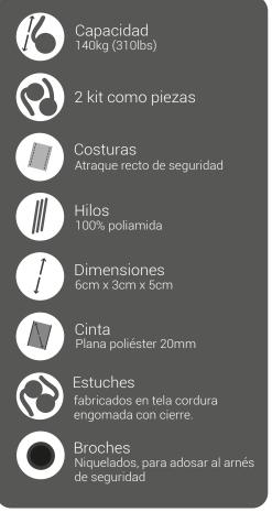
La cinta Anti-trauma EQS es un accesorio diseñado para su uso con arneses anticaídas. El accesorio consiste en una cinta enrollada y fijada al arnés anticaídas mediante una bolsa a la altura de la cintura del usuario.
